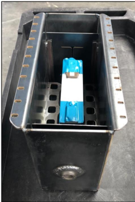
圖 9：帶電池的浸液測試設置在 AmpCool™ AC100 中
