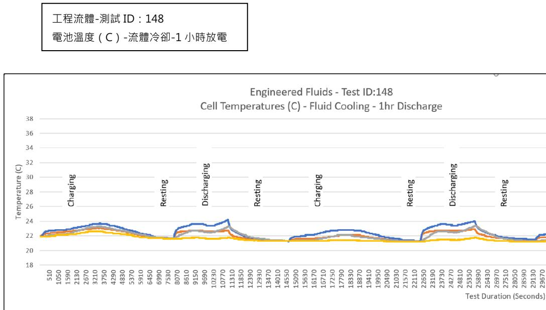
圖 14：液冷電池測試 - 第二階段充電/放電週期
