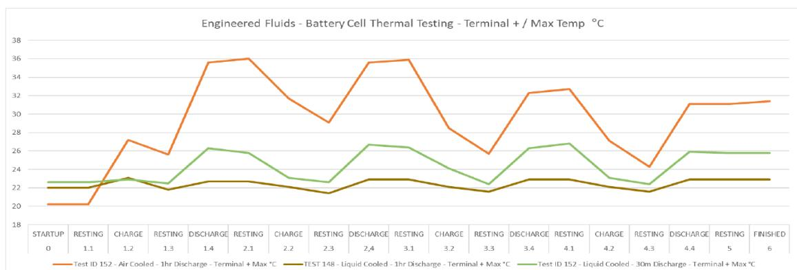
圖 16：冷卻性能比較 - 電池正極端子/最高溫度 C
