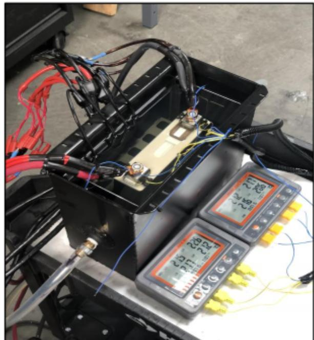
圖 10 提供了用於在測試過程中容納電池的鋼製測試箱內部容積的尺寸。該儲罐由 12 冷軋鋼製成，作為測試期間電池過熱的安全措施。即使在液體冷卻時由於非常激進的放電而產生額外的壓力，也不曾將電池溫度推升至 27C 以上，該溫度接近 120C 時會產生熱失控溫度。
