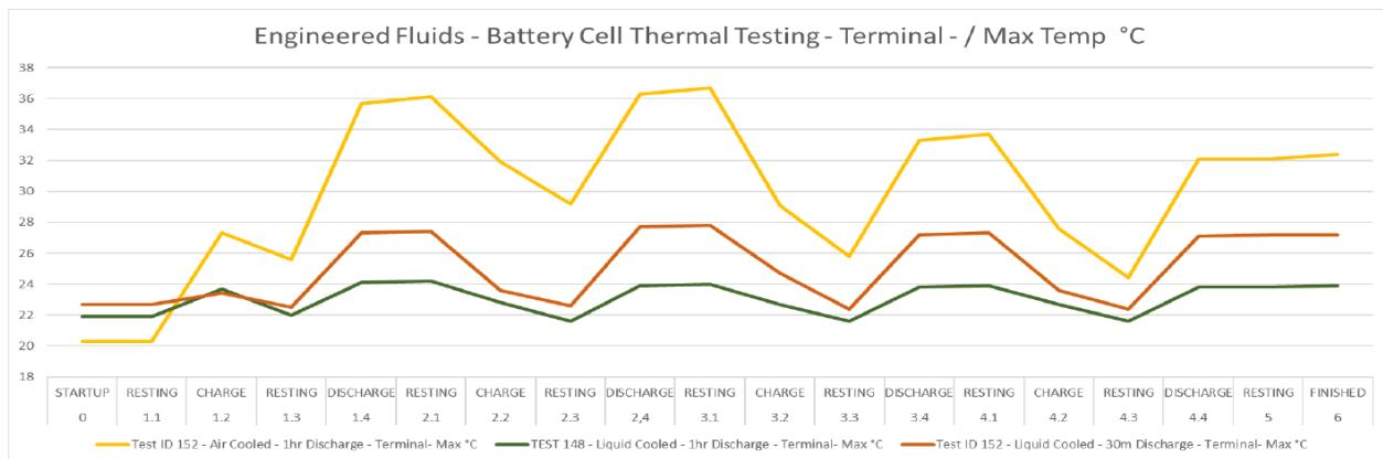
圖 18：冷卻性能比較 - 電池單元長壁/最高溫度 C
